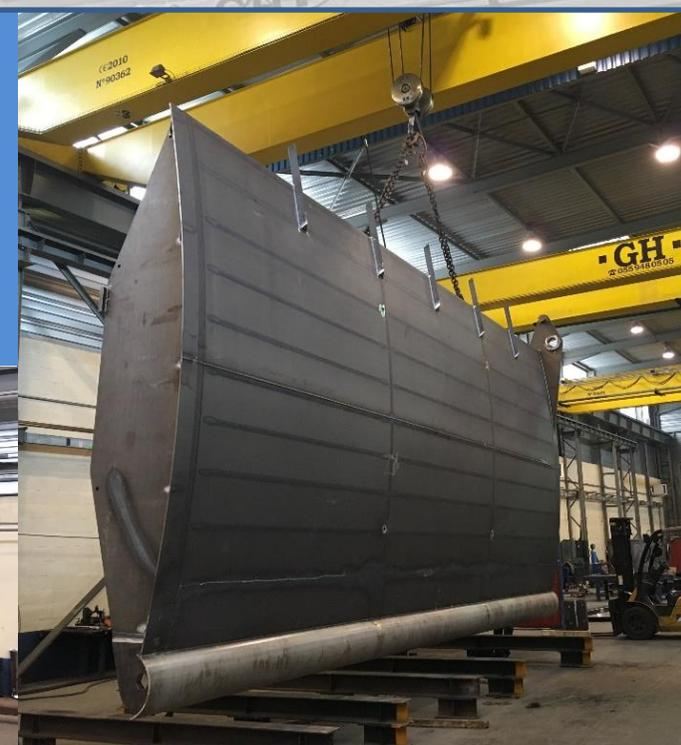
De l'installation légère (pour la pisciculture) aux machines de plus de 20 tonnes, les dégrilleurs Hydroeo sont intégralement conçus et fabriqués dans nos ateliers, montés à blanc, et réceptionnés avant expédition. Ils sont dimensionnés pour une utilisation continue dans des environnements difficiles
